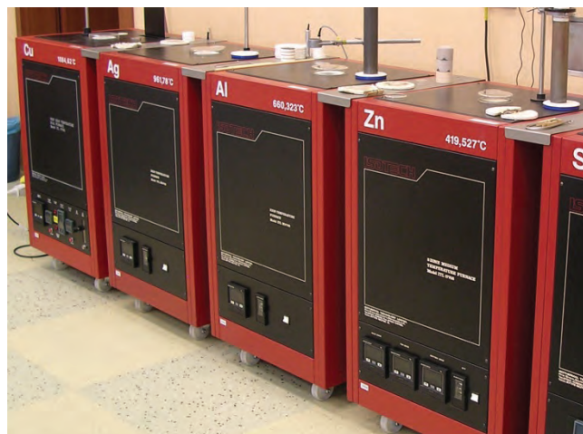
Obr. 1: Pohled na termostaty státního etalonu
