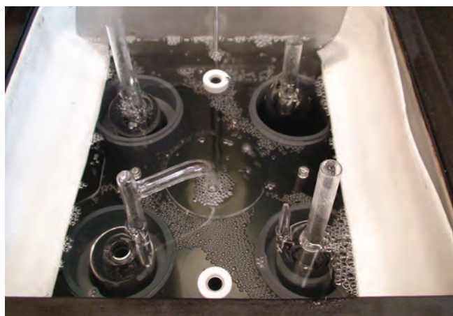
Obr. 2: Pohled na uložení kyvet trojného bodu vody v lázni
