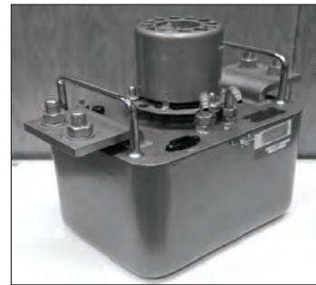
Obr. 5.1.5: Nízkoohmový etalón ZIP typ P 323 hodnoty 0,0001 \Omega pre prúdy 320 \text{ A} (max. do 1000 \text{ A} )
