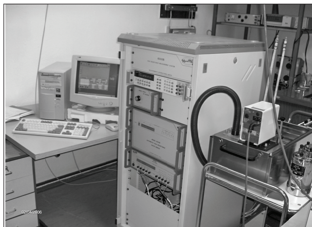
Obr. 5.3.10: Zostava meracieho zariadenia MI Model 6000B na meranie veľkých odporov
