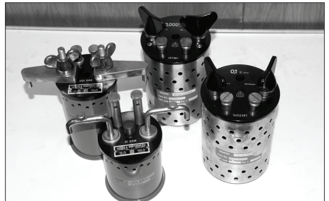
Obr. 5.1.6: Nízkoohmové etalóny Metra, typ RN hodnôt 0,1 \Omega a 0,0001 \Omega a Leeds & Northrup, typ 4222-B 0,01 \Omega a typ 4223-B 0,001 \Omega
