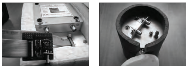
Obr. 6.3.2: Transportní etalony pro navázání měření činitele ztrát kondenzátorů. Upravené cestovní etalony AH 11 (vlevo) se speciálním zdrojem GR 1404 (vpravo)
