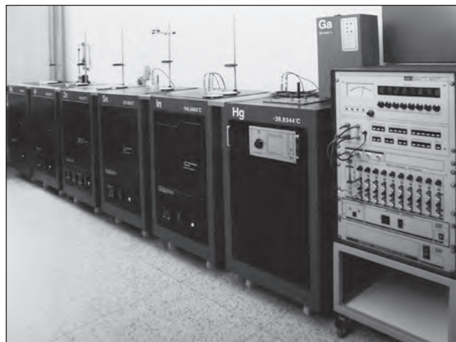
Obr. 2: Mezinárodní teplotní stupnice ITS-90 pro ČR realizovaná v Primární laboratoři ČMI v Praze
