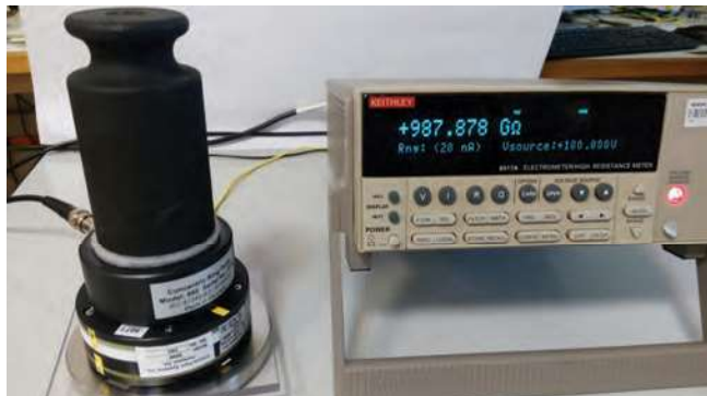
Obr. 5: Příklad měření elektrometrem Keithley 6517A na kalibračním přípravku
