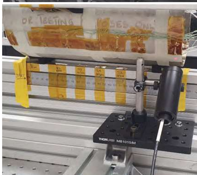
Obr. 3: Nahore: SNM kontejner na stojanech v provozu. Dole: Kontejner SNM v laboratoři v NPL prochází fosforovými termometrickými testy (světlý svislý pruh je fosfor na plechovce, červená skvrna je místo, kde je snímána povrchová teplota). Převzato z (1).
