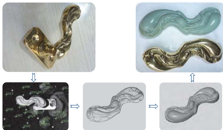
Obr. 4: Využití 3D skenování pro 3D tisk
