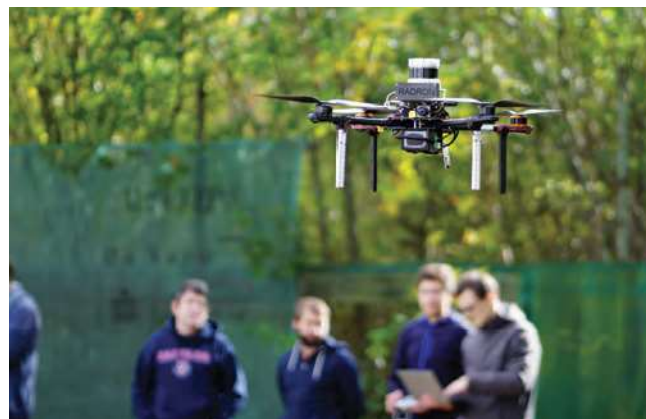
Obr. 4: Dron postavený vědci z FEL nesoucí LIDAR a detektor MiniPIX během testovacího letu.
