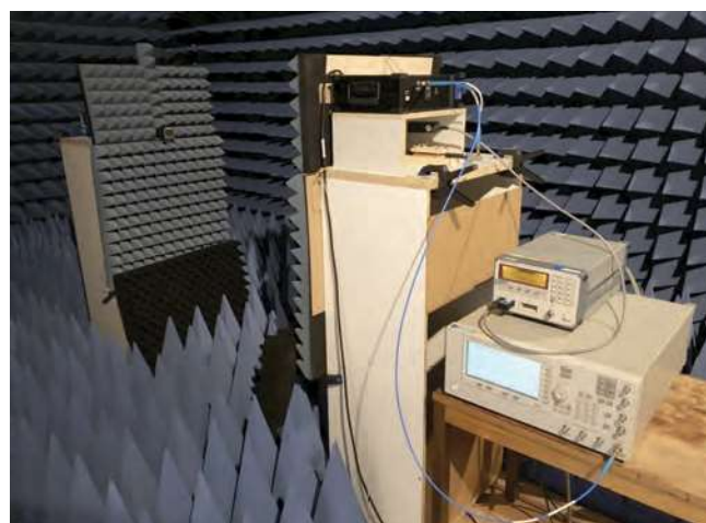
Obr. 7: Ukázka měřicího pracoviště při ověřování dosažitelné intenzity pole v pásmu 18 GHz až 26,5 GHz
