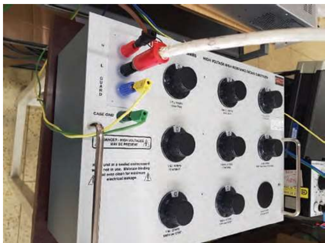
Obr. 2: Zapojení VN vysokoohmové dekády s uzemněním neživých částí
