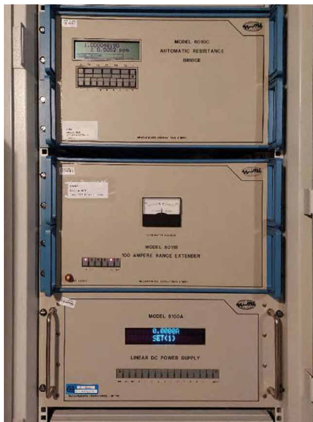
Obr. 1: Příklad sestavy pro kalibrace nízkoohmových odporových mostů
