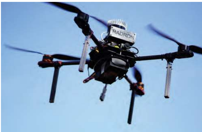
Obr. 1: RaDron – bezpilotní letecký prostředek pro lokalizaci zdrojů ionizujícího záření.
