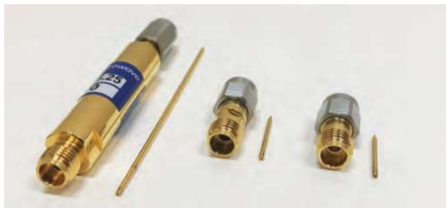
Obr. 8: Sada etalonových linek s konektory 2,4 mm pro kmitočty do 50 GHz s vypočítatelnými vlastnostmi
