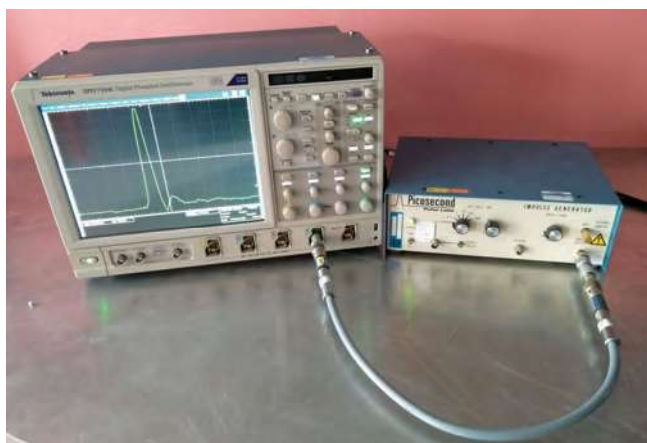
Obr. 11: Ukázka kalibrace impulzního generátoru podle CISPR 16-1-1
