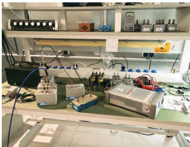
Obr. 6: Pracoviště s elektrometrem, referenčním etalonem kapacity a odporu
