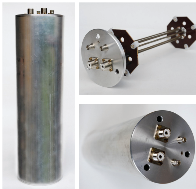
Obr. 3: Fotografie realizovaného bočnicku: stínicí kryt (vlevo), proudové a napěťové konektory (vpravo dole) a odporový element (vpravo nahoře)
