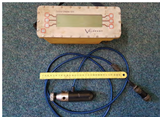
Obr. 3: Vyhodnocovací jednotka, kabel a snímač EMI-měřidla Valeport - Cylindrical (DHI)
