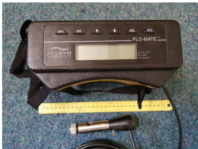
Obr. 5: Vyhodnocovací jednotka, kabel a snímač EMI-měřidla FLO-MATE 2000 (BVK)
