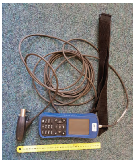
Obr. 6: Vyhodnocovací jednotka, kabel a snímač EMI-měřidla MF Pro (PVK)
