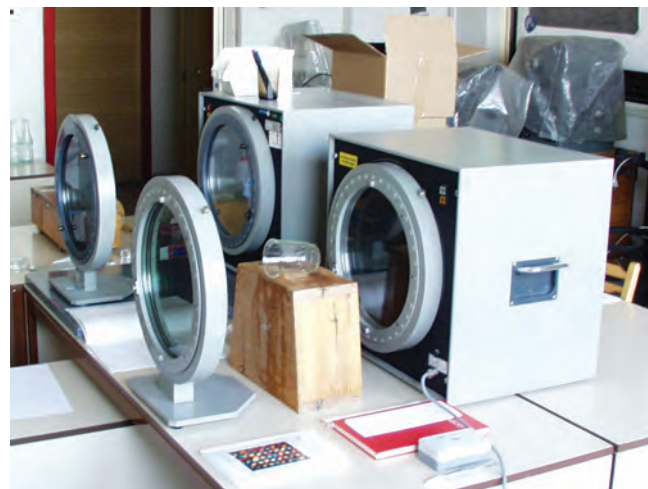
Obr. 4: Polarimetr Schneider, Model Nr. 1115, se Sénarmontovým kompenzátorem, umožňuje měřit v bílém světle nebo v monochromatickém světle sodíkové výbojky
