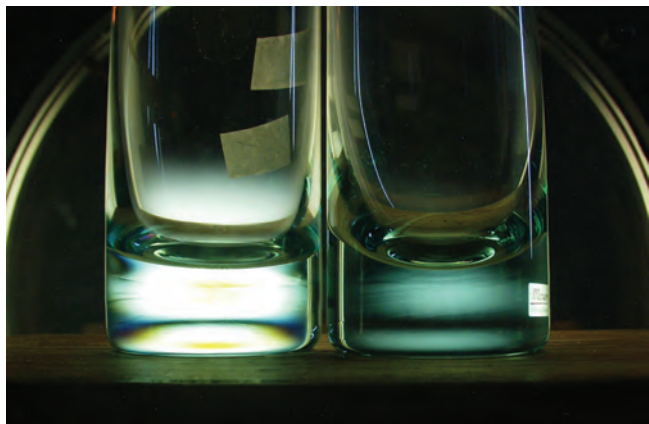
Obr. 2: Vzhled výrobků s dráhovým rozdílem menším než jeden řád v temném poli polariskopu (vlevo vyšší, vpravo nižší vnitřní napětí)
