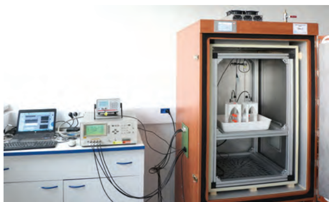
Obr. 3: Celkový pohled na sestavu státního etalonu elektrolytické konduktivity. Vlevo měřicí most Agilent, vpravo sestava konduktometrické cely ve vzdušném termostatu.
