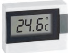
Obr. 1: Příklad rozlišení při měření teploty teploměrem s číselným displejem (s rozlišením 0,05°C)
