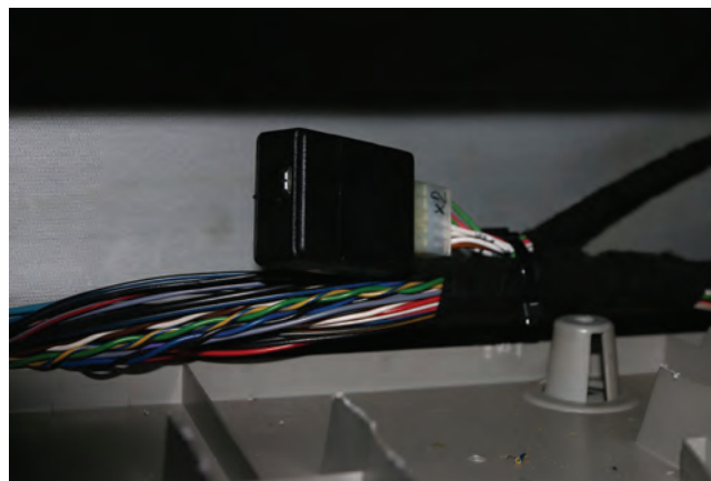
Obr. 5: Detailní pohled na modul pro korekci signálu tachografu
