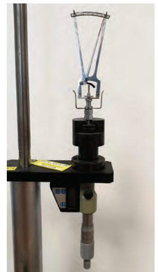
Obr. 5: Zkouška zdvihu peloty Shiotzova tonometru
