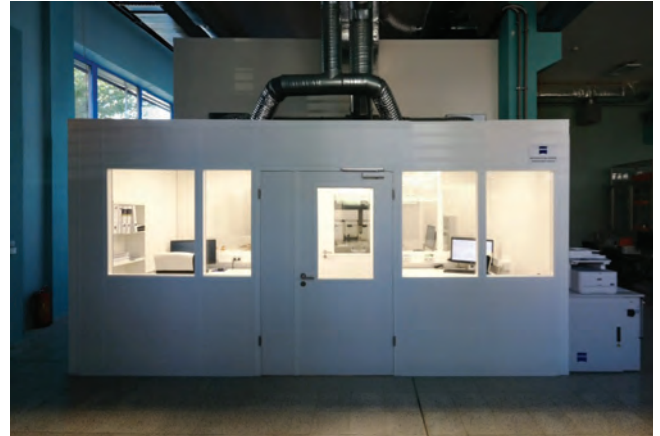
Obr. 3: Klimatická komora s etalonovým strojem ZEISS XENOS
