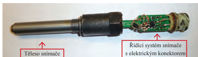
Obr. 1: Stav snímače impulzů při prohlídce
