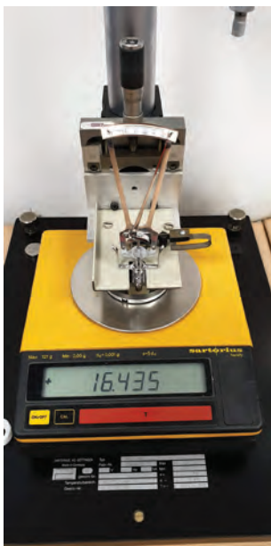
Obr. 2: Kontrola celkové hmotnosti Shiotzova tonometru
