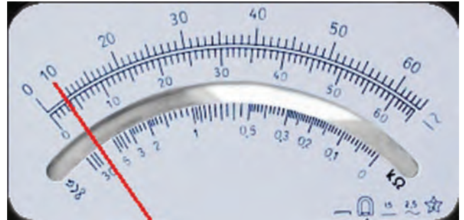
Obr. 4: Analogový přístroj, za pozornost stojí i nožová ručka a podkladní zrcátko, které umožňují potlačit chybu čtení vlivem paralaxy (šikmého pohledu)
