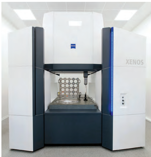
Obr. 3: Klimatická komora s etalonovým strojem ZEISS XENOS
