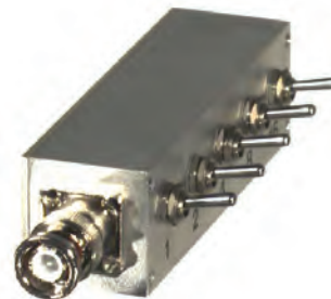
Obr. 5: Referenční útlumový článek (rozlišení je podle poslední nastavitelné polohy, zde 0,0005 dB)
