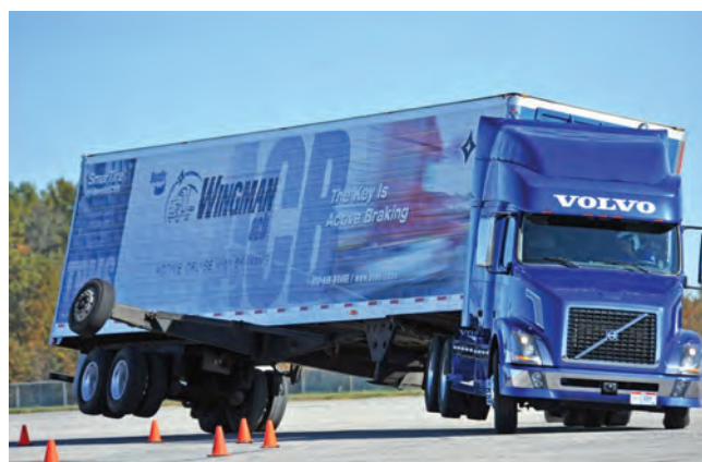
Obr. 8: Ukázka kolizní situace bez aktivního stabilizačního systému
