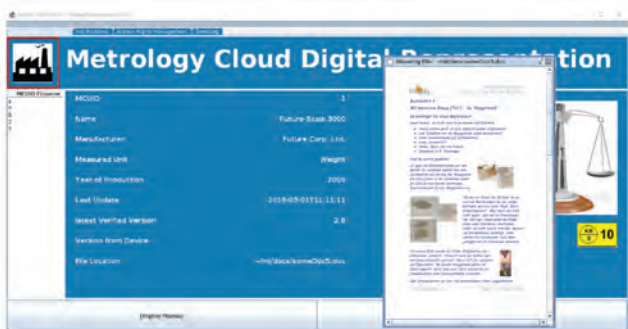
Obr. 4: Ukážka: digitálna reprezentácia meracieho zariadenia v EMC z profilu výrobcu [1].
