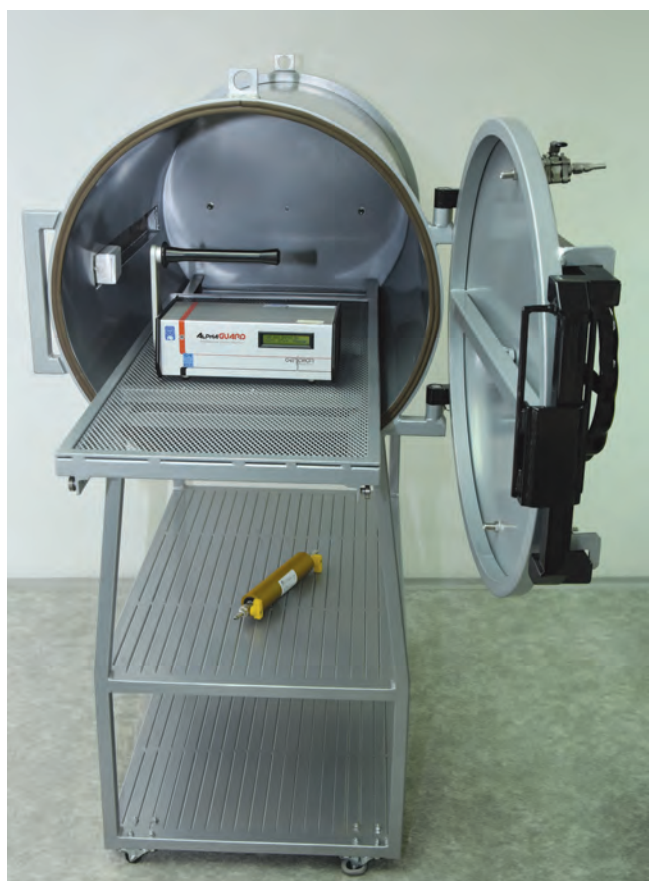
Obr. 2: Radonová komora (LLRCH) v laboratoři Autorizovaného metrologického střediska SÚJCHBO, v.v.i.
