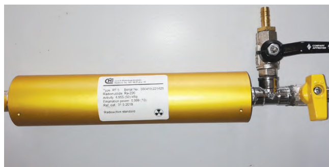
Obr. 3: Průtočný zdroj radonu RF5 vyvinutý ČMI
