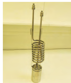
Obr. 3: Rozbraný a sestavený referenční saturátor
