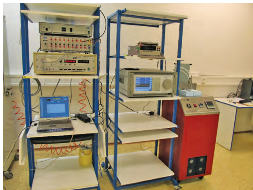
Obr. 2: Celková sestava – zleva teplotní most, rosnobodový vlhkoměr, kapalinová lázeň se saturátorem
