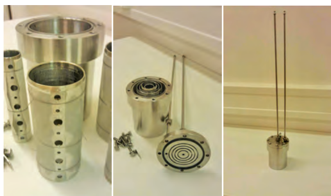
Obr. 6: Rozebraný a sestavený presaturátor
