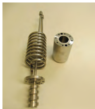
Obr. 3: Rozbraný a sestavený referenční saturátor
