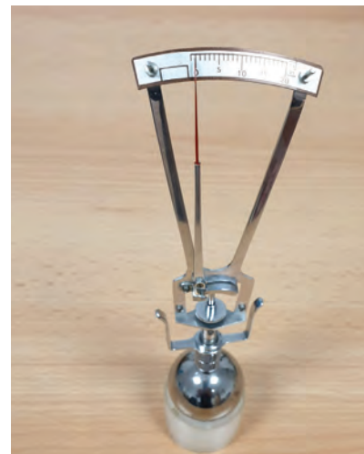
Obr. 16: Kontrola údajů impresního tonometru na testovacím kulovém bloku
