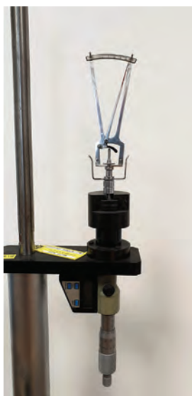
Obr. 18: Kontrola posunu peloty impresního tonometru
