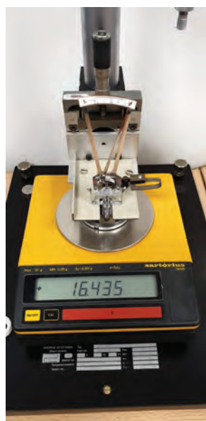
Obr. 15: Kontrola hmotnosti impresního tonometru
