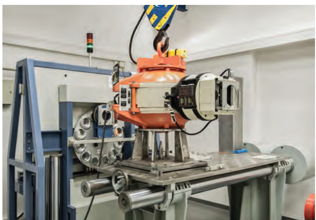
Obr. 30: Ozařovač Chisobalt se zdrojem záření gama ^{60}\text{Co}
