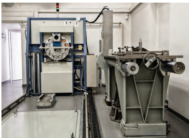
Obr. 29: Rentgeny 160 kV a 320 kV ve společném stínění a se společným kolem s filtry
