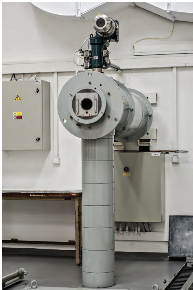
Obr. 31: Ozařovač G7 se čtyřmi zdroji záření gama ^{137}\text{Cs} a třemi zdroji ^{60}\text{Co}
