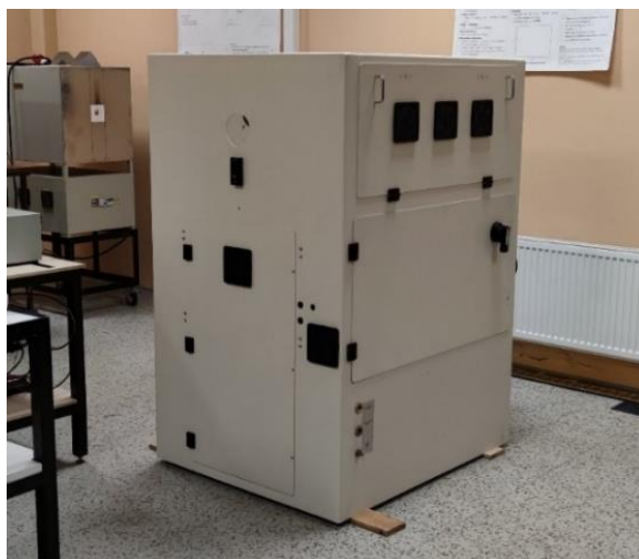
Obrázek 25 - Vysokoteplotní pec Thermo Gauge HT-9500
