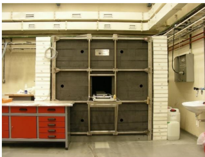
Obrázek 36 - Státní etalon příkonu fluence tepelných neutronů
