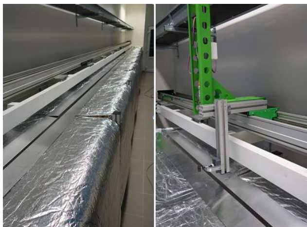
Obrázek 17 - Primární etalon rychlosti proudění vzduchu na principu tažné tratě
