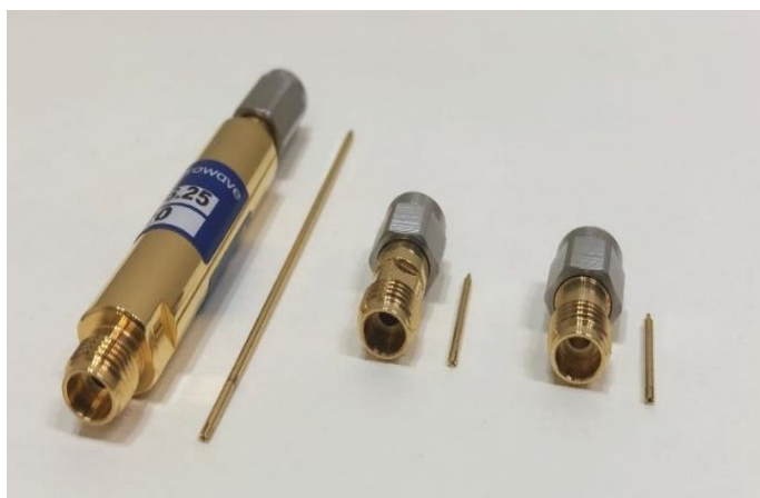
Obrázek 8 - Sada etalonových linek pro kmitočty do 50 GHz s vypočitatelnými vlastnostmi
