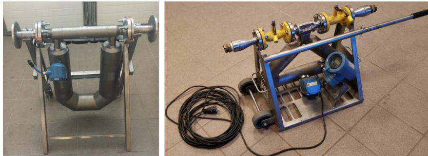
Obrázek 15 - Hmotnostní průtokoměry CMF 200 M a CMF 100 M pro minerální oleje, LPG a jiné kapaliny na bázi uhlovodíků (zleva)
