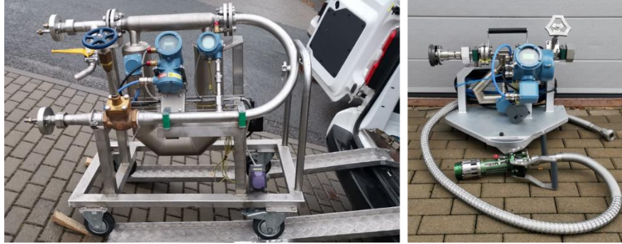
Obrázek 14 - Hmotnostní průtokoměry CMF 200 M a CMF 050 M pro kryogenní kapaliny a LNG (zleva)
