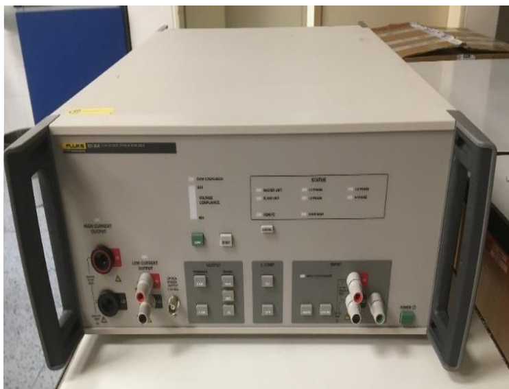
Obrázek 6 - Transkonduktanční zesilovač 52120A
