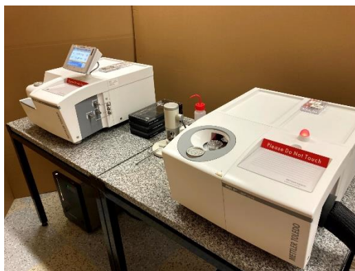
Obrázek 29 - DSC - diferenční skenovací kalorimetr (DSC 3+) a TGA - přístroj pro termogravimetrickou analýzu
