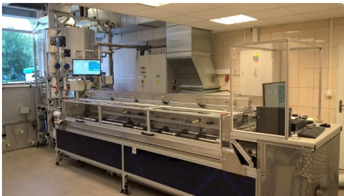
Obrázek 13 - Primární etalon průtoku vody s pístem
