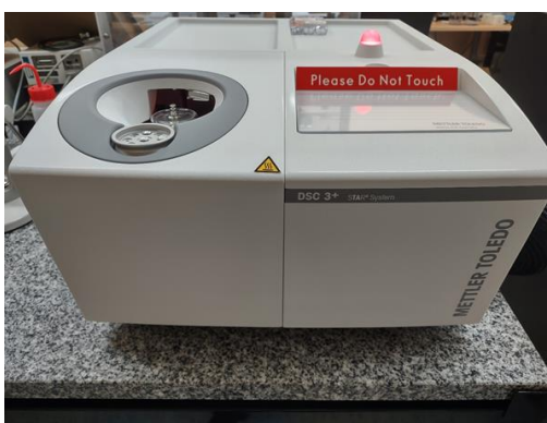
Obrázek 31 - Diferenciální skenovací kalorimetr (DSC 3+)
