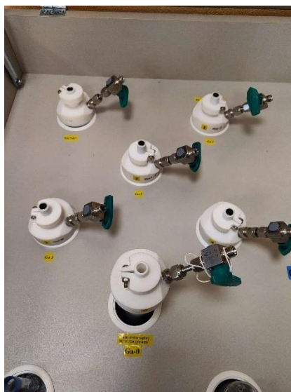
Obrázek 22 - Exempláře pevného bodu Galia s příměsí nečistot různého složení (In, Sn, Zn, Al, Cu)
