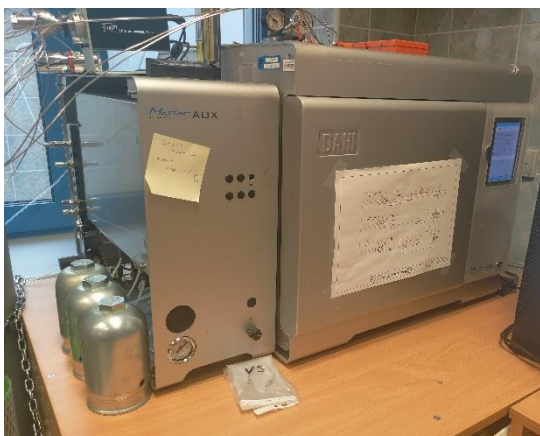
Obrázek 12 - Plynový chromatograf pro analýzu zemního plynu s obsahem vodíku, kyslíku, helia a uhlovodíků do C12
