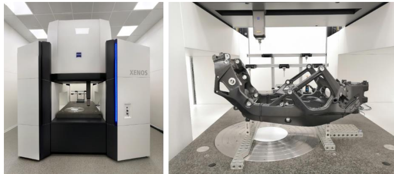
Obrázek 44 - Souřadnicový měřicí stroj Zeiss XENOS
