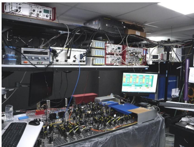
Obrázek 47 - Sestava čtyř pomocných stabilizovaných laserů a vlnoměru, v pozadí hodinový laser 435nm v akusticky a vibračně izolačním boxu
