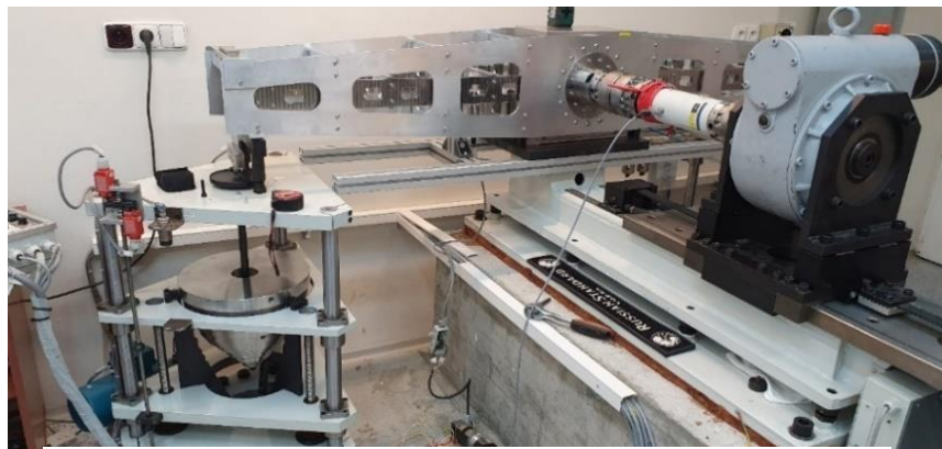
Obrázek 34 - Etalon momentu síly EZMS 1 kN·m a CMC=0,01%
