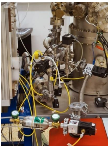
Obrázek 40 - Rozšíření státního etalonu vysokého vakua pro velmi nízké proudy He
