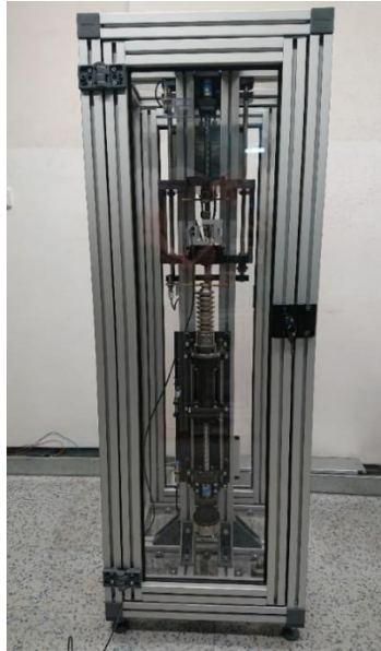
Obrázek 32 - Etalon síly ESZ 10 N s rozsahem 1 až 10 N a CMC=0,004%
