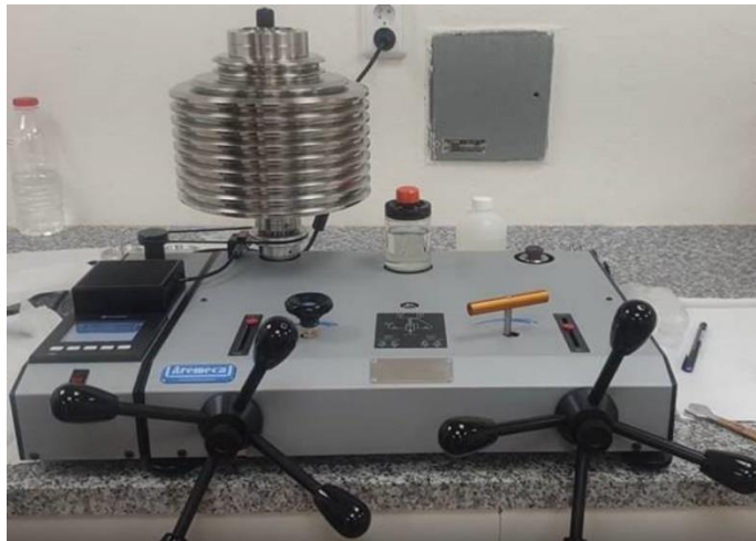
Obrázek 41 - Etalon vysokého přetlaku v olejovém médiu do 1 GPa Arémeca BH5-1000B
