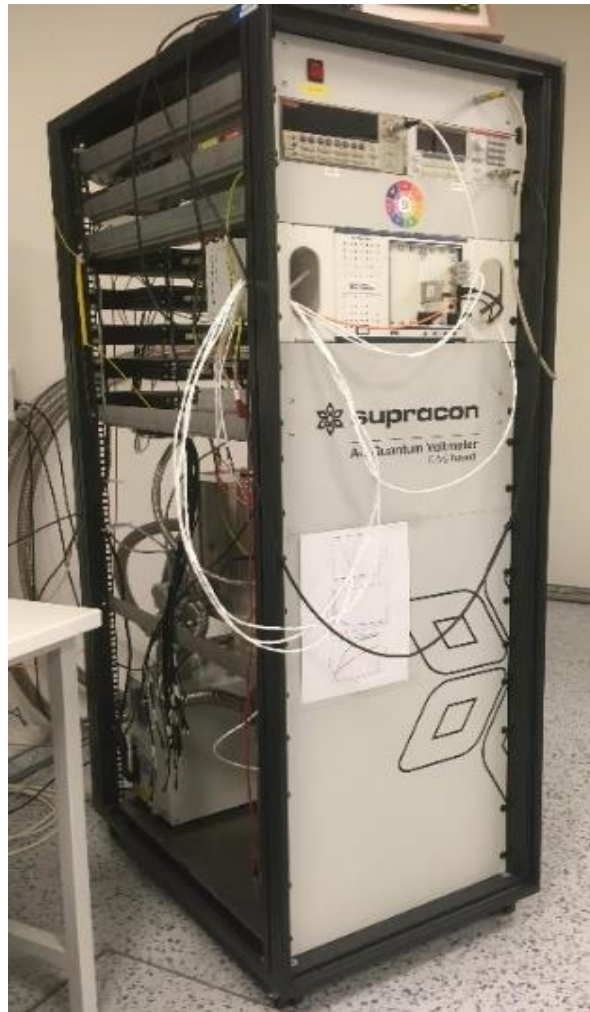
Obrázek 4 - Programovatelný etalon střídavého napětí (PJVS)
