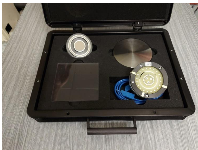
Obrázek 3 - Sonda s podložkou Wolfgang Warmbier 880 a kalibrační přípravek Electro-Tech System 809B
