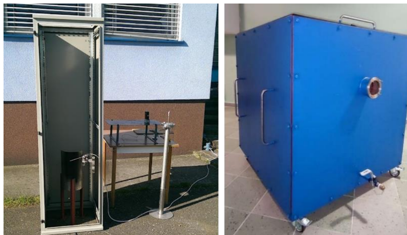
Obrázek 24 - Testovací sestava pro zkoušku termokamer detekujících úniky plynů za normálních podmínek, Komora umožňující stabilizaci požadovaných okolních podmínek (teploty a vlhkosti) při testování termokamer detekujících úniky plynů
