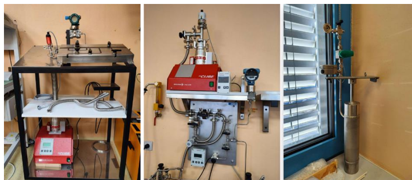
Obrázek 21 - Mobilní systém argonového hospodářství, Pevný bod CO 2 s teplotou realizace okolo -56,6 °C, Systém plynového hospodářství s fixní polohou
