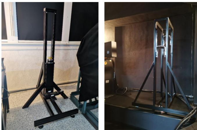
Obrázek 54 - Automatizovaná kalibrační aparatura pro měření retro-reflexních materiálů pro vodorovná a vertikální dopravní značení
