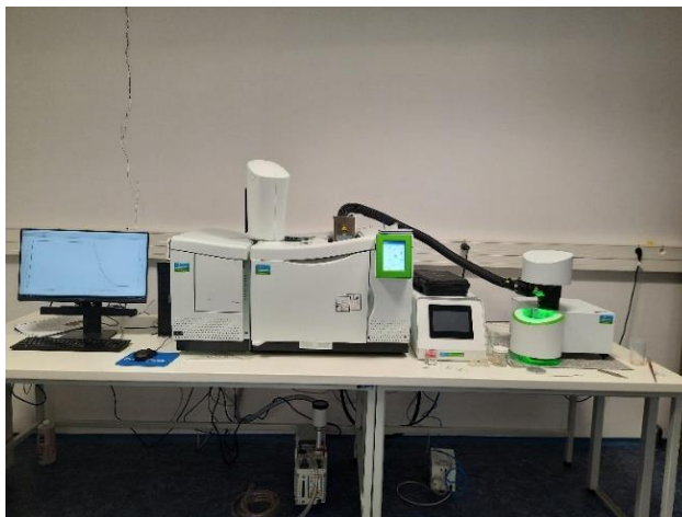
Obrázek 27 - TGA-GC/MS - termogravimetrie ve spojení s plynovou chromatografií s hmotnostní detekcí
