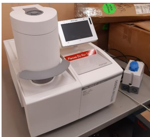
Obrázek 30 - Termomechanický analyzátor (TMA/SDTA 2+)
