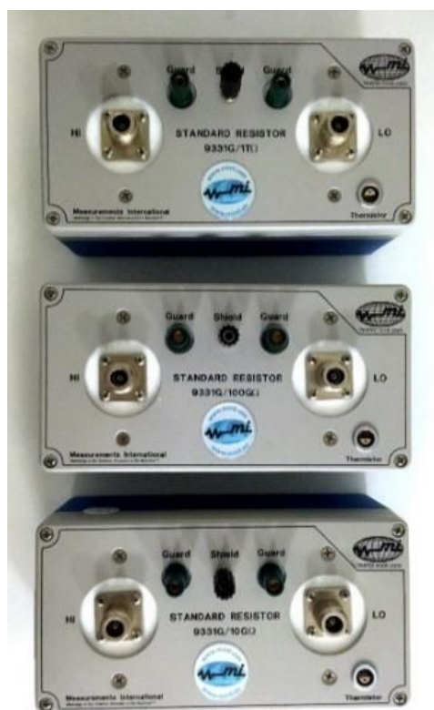
Obrázek 5 - Etalony odporu Measurements International 10 GΩ - 1 TΩ
