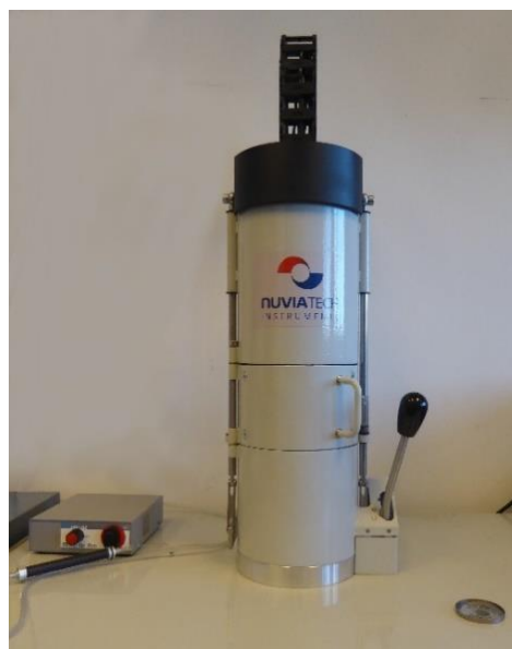
Obrázek 35 - 4\pi\text{NaI(Tl)} detektor s velmi tenkým okénkem pro měření záchytových nuklidů s energií záření X (20-100) keV
