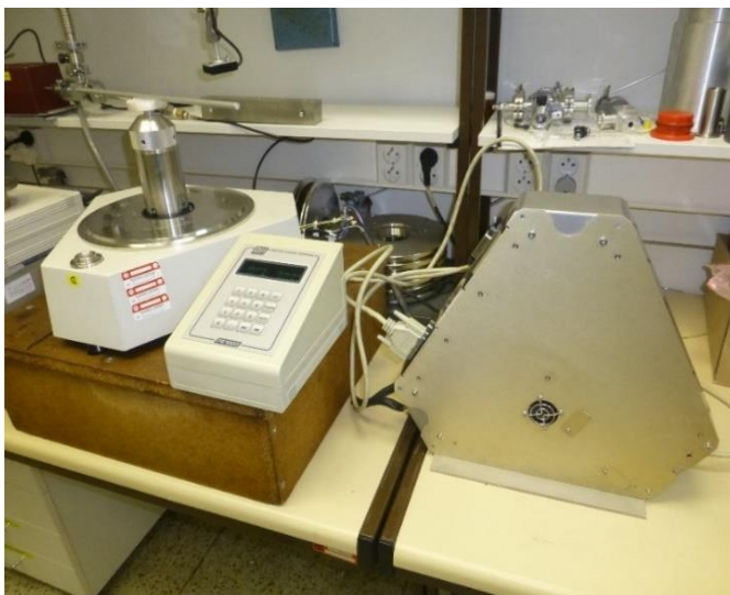
Obrázek 37 - Teplotně inaktivní základna státního etalonu přetlaku, podtlaku a absolutního tlaku v plynném médiu
