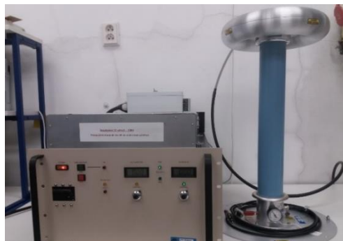
Obrázek 2 - Regulovatelný DC zdroj Glassman 100 kV/5 kW a DC dělič Ross Engineering Corp
