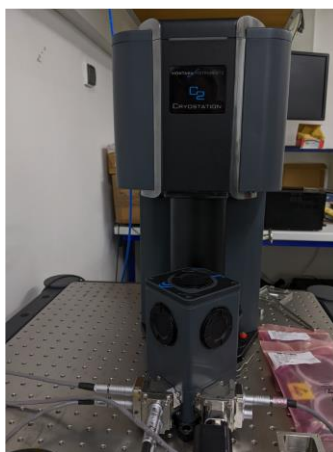
Obrázek 51 - Heliový kryostat ČMI s uzavřeným chladícím okruhem
