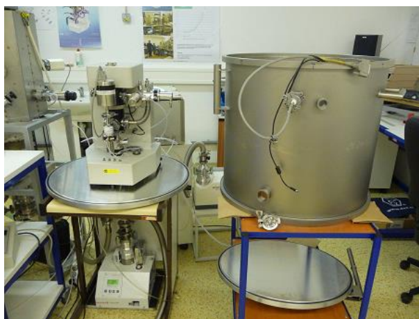
Obrázek 38 - Hermetický systém pro státní etalon vakua
