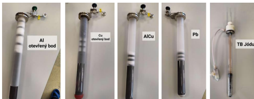
Obrázek 20 - Otevřené pevné body Al a Cu, Eutektický bod AlCu (548,16 °C), Pevný bod olova (387,5 °C), Trojný bod jodu (114,9 °C)
