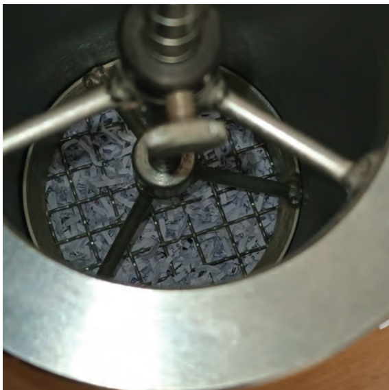
Obr. 2: Měření odporu proti proudění vzduchu podle ČSN EN ISO 9053-1
