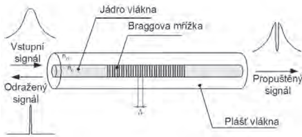
Obr.1: Základní princip funkce FBG
