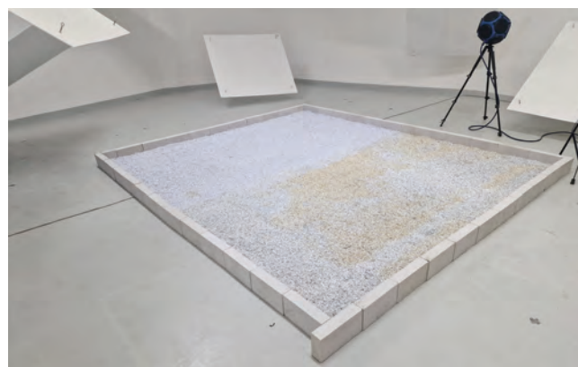
Obr. 3: Měření zvukové pohltivosti papírové vlny v dozvukové komoře
