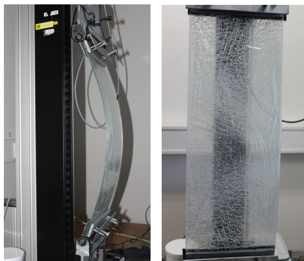
Obr. 8: Pohled na zkušební sestavu při zkoušce ohybu při vzpěru
