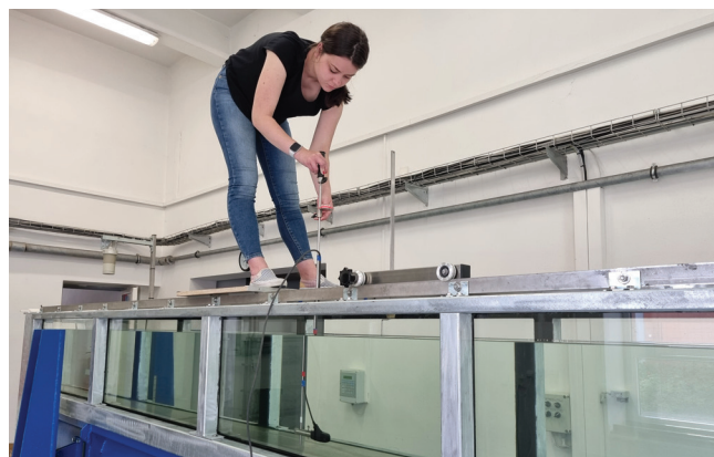
Obr. 6: Realizace ručního integračního měření na hydraulickém měrném žlabu 40
