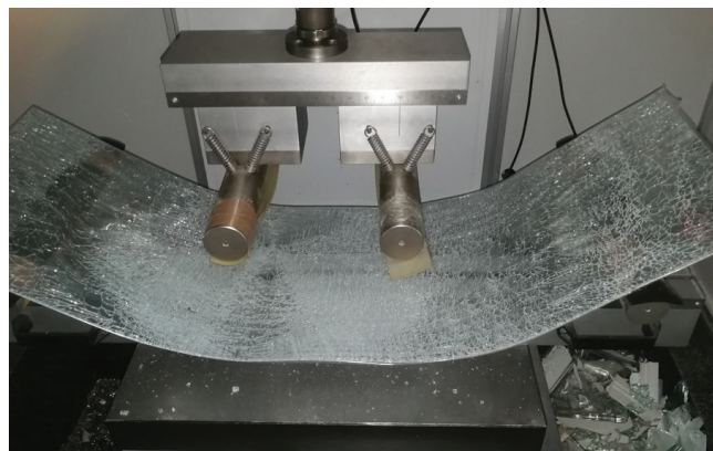
Obr. 6: Pohled na zkušební přípravek při čtyřbodovém ohybu
