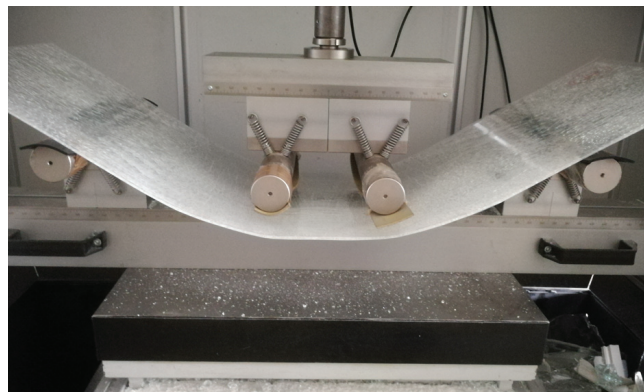
Obr. 5: Pohled na zkušební přípravek při čtyřbodovém ohybu, rozteč 800 mm
