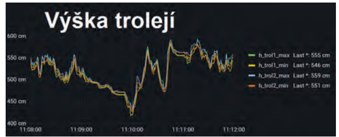
Graf 7: Výška trolejí (+trolej, -trolej) v daném úseku, záznam v čase při průjezdu měřeným úsekem 766 Šancová – Pražská. [9]
