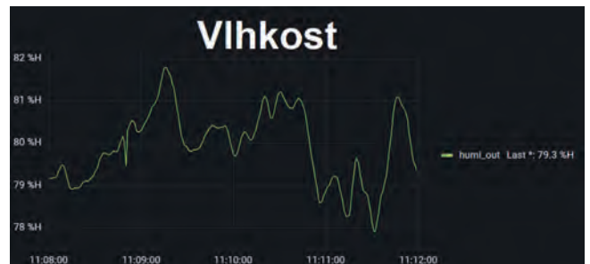
Graf 9: Vlhkost – záznam v čase při průjezdu měřeným úsekem 766 Šancová – Pražská. [9]
