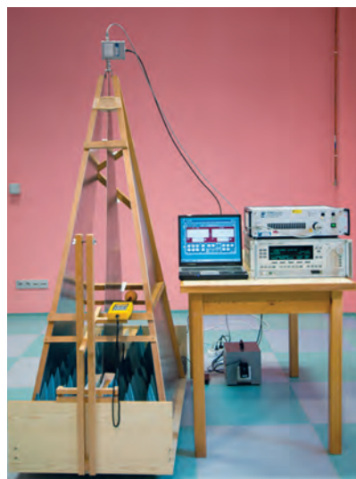
Obr. 4: Kalibrace měřidel intenzity elektromagnetického pole v pyramidální TEM cele
