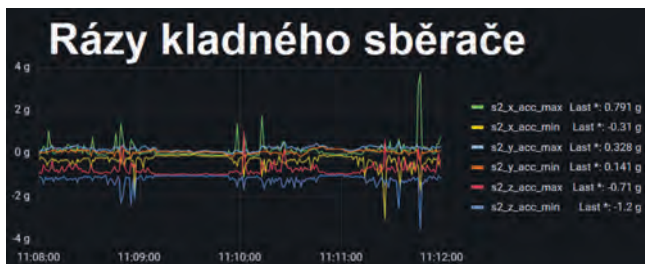
Graf 5: Rázy kladného sběrače – záznam v čase – při průjezdu měřeným úsekem 766 Šancová – Pražská. [9]
