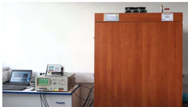
Obr. 2: Realizace státního etalonu elektrolytické konduktivity v rozsahu (0,055 - 50) \mu\text{S}\cdot\text{cm}^{-1}
