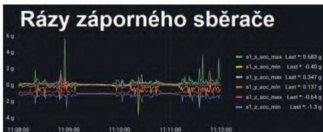
Graf 6: Rázy záporného sběrače – záznam v čase – při průjezdu měřeným úsekem 766 Šancová – Pražská. [9]
