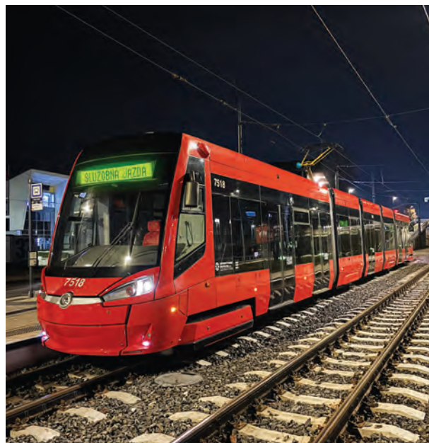
Obr. 1: Běžná provozní tramvaj Škoda 30T jako námrazové vozidlo v ulicích Bratislavy. Zdroj: Vlastní.
