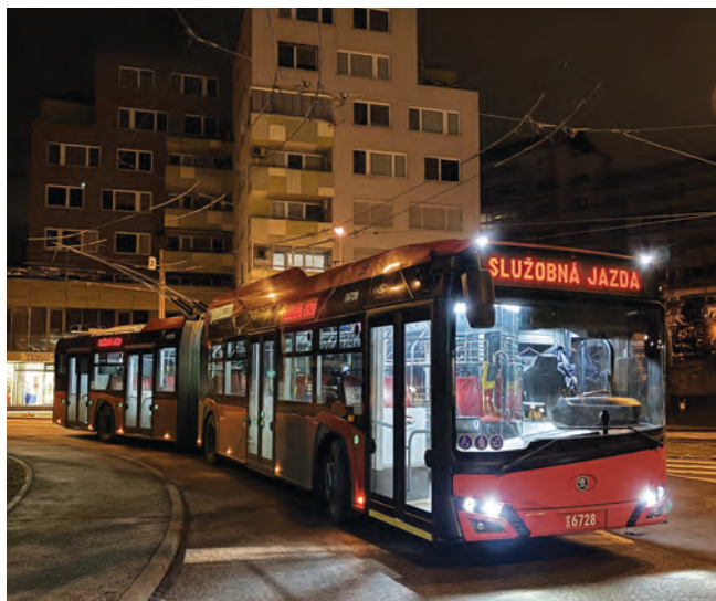
Obr. 2: Běžný provozní trolejbus Škoda 27Tr Solaris s provozními trakčními bateriemi pro případ potřeby alternativního pohonu vozidla během námrazy jako námrazové vozidlo v ulicích Bratislavy. Zdroj: Vlastní.
