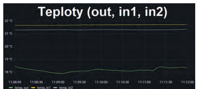
Graf 10: Zaznamenaná teplota – venkovní (out), vnitřní 1 (in1) a vnitřní 2 (in2), záznam v čase při průjezdu měřeným úsekem 766 Šancová – Pražská. [9]
