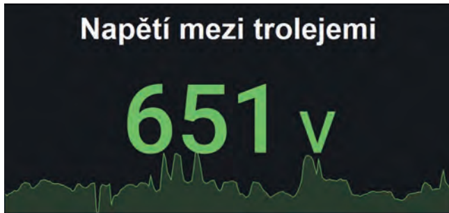
Graf 2: Napětí mezi trolejemi při průjezdu měřeným úsekem 766 Šancová – Pražská, průměrné napětí ve vedení (v tomto úseku) 651 V. [9]
