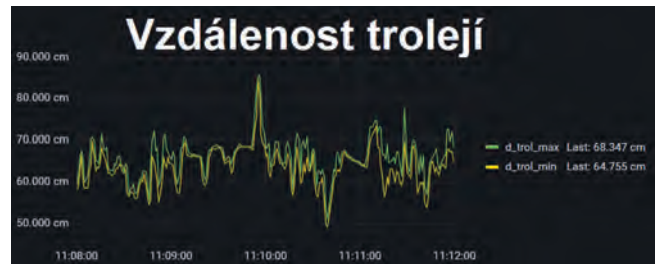
Graf 8: Vzdálenost vodičů trolejového vedení od sebe v daném úseku, záznam v čase při průjezdu měřeným úsekem 766 Šancová – Pražská. [9]
