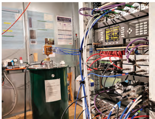
Obř. 3: Kryogenní aparatura (vlevo) s kvantovým střídavým odporem na bázi grafenu a s digitálním impedančním můstkem (vpravo) pro charakterizaci grafenových struktur.
