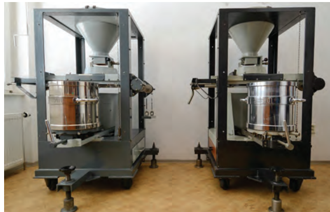
Obr. 1: Statní a svědecký etalon objemové hmotnosti obilovin
