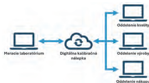
Obr. 2: Schéma riešenia digitálnej kalibračnej nálepky pomocou cloudového úložiska. Zdroj: Vlastné spracovanie.
