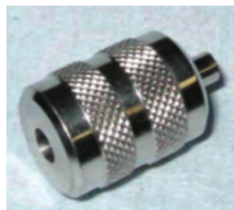
Obr. 11: Kalibrační etalonová měrka pro N-konektory
