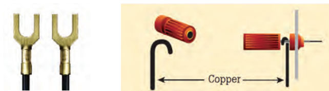
Obr. 4: Zakončení vodičů. Vidlička. Připojení očka holého vodiče při měření malých odporů. (zdroj obrázku - www.fluke.com/library )
