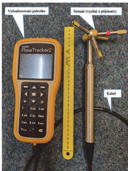
Obr. 1: Vyhodnocovací jednotka, kabel a snímač měřidla FlowTracker2 – 3D verze
