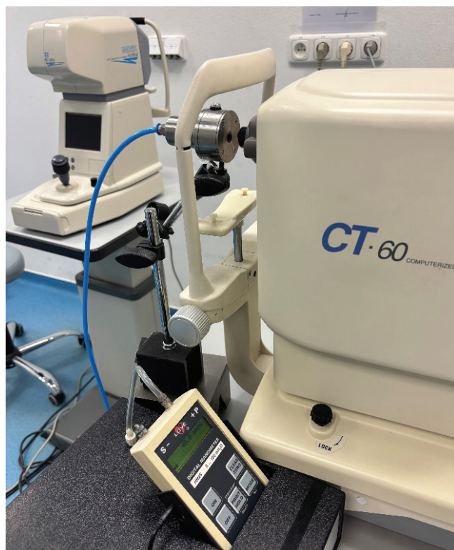
Obr. 2: Etalonové zařízení s modelovým okem umístěné na bezkontaktním očním tonometru během experimentů. Zdroj: Vlastní.
