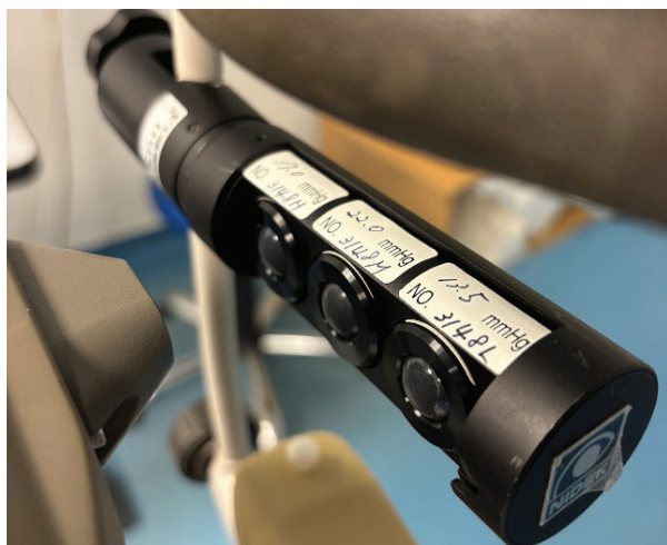
Obr. 1: Silikonové oči umístěné na bezkontaktním očním tonometru během experimentů. Zdroj: Vlastní.
