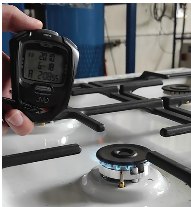
Obr. 4: Zkouška časového limitu pojistky plamene
