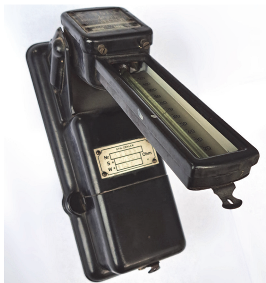
Obr. 3: Nulování elektroměru překlopením kapiláry
