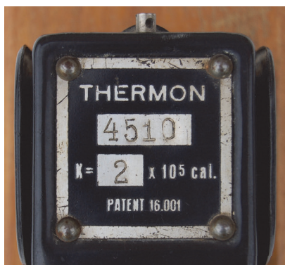
Obr. 13: Stupnice indikátoru cejkovaná v násobcích 10^5 kalorií
