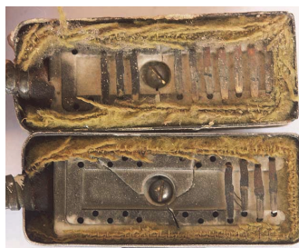
Obr. 9: Počet termočlánků ve snímači na radiátoru odpovídá jeho výkonu
