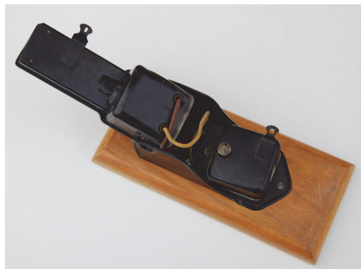
Obr. 11: Nulování indikátoru překlopením kapiláry
