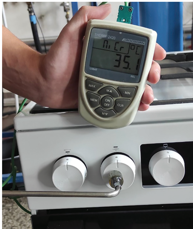
Obr. 7: Měření povrchové teploty ovladačů
