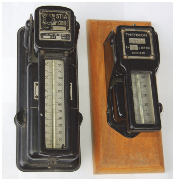
Obr. 12: Nemí překvapivé, že elektroměr STIA a měřidlo tepla THERMON jsou vzhledově téměř identické
