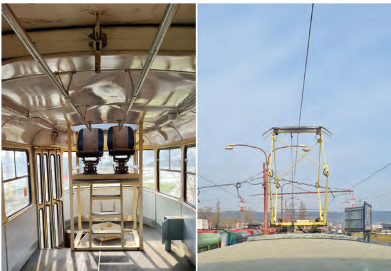
Obr. 3: Sedadla a střešní nástavba s výhledem v měřicím vozidle Tatra T3 na kontrolu trolejového vedení, výhled na trolejové vedení. Dopravní podnik Bratislava, a. s. Zdroj: Vlastní.
