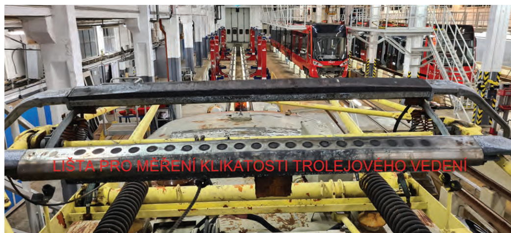
Obr. 1: Lišta pro měření klikatosti trolejového vedení. Zdroj: Vlastní.
