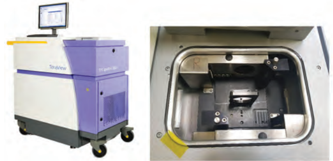
Obr. 4: Fotografie komerčního systému TPS spectra 3000 (TeraView). Vlevo celkový pohled, vpravo komora pro vložení materiálu (ochranná atmosféra pro eliminaci absorpčních čar vodní páry).
