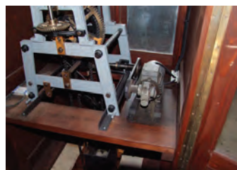
Obr. 8: Elektromotor pravidelně vy- zdvhuující hodinové závaží
