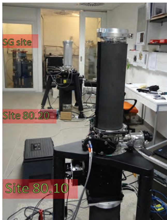
Obr. 1: Pohled na gravimetrickou laboratoř na stanici Pecný. V popředí gravimetr FG5X-251/HS5 na bodě 80.10, uprostřed FG5-215/HS5 na bodě 80.20 a v pozadí supravodivý gravimetr OSG-050.
