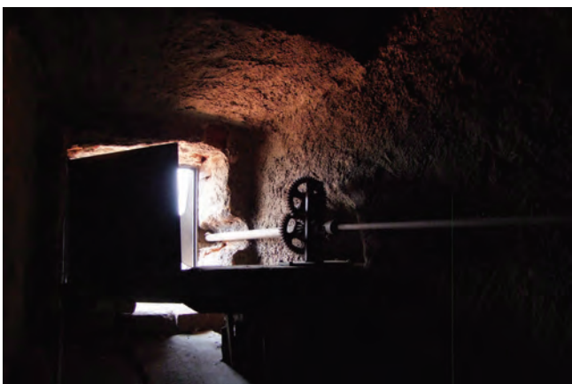
Obr. 10: Redukční soukolí u dvouručičkového ciferníku
