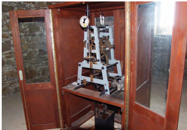
Obr. 5: Hodinový stroj obou věžních hodin
