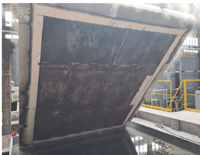
Obr. 4: Vložení vzorku do kádě s vodou po požární zkoušce
