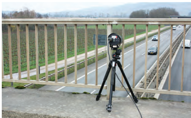
Obr. 2: Systémy VKS monitorující rychlost a dodržování bezpečné vzdálenosti jsou obvykle umísťovány na dálničních mostech
