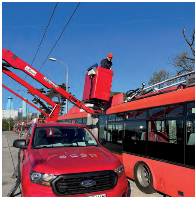
Obr. 4: Kontrola a nastavení přítlaku pomocí pružin (1) – doc. Rybář. Zdroj: Vlastní.
