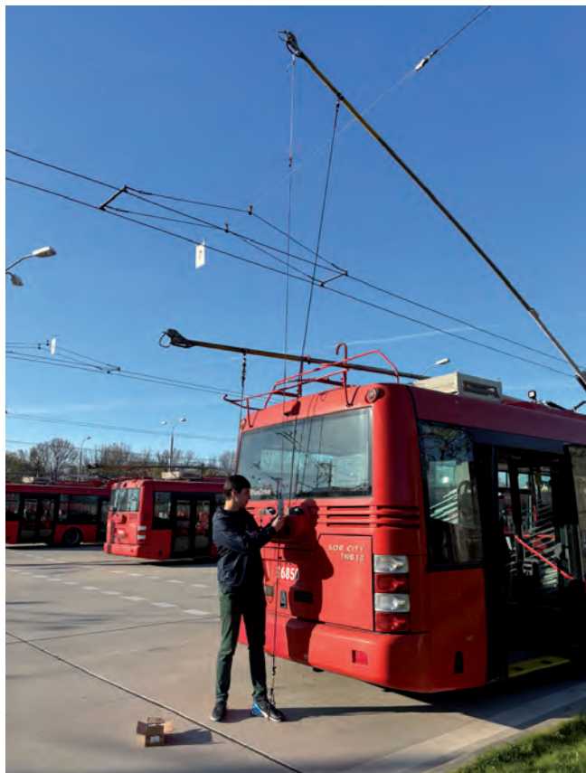
Obr. 2: Měření přítlaku na sběrací hlavici 2 (pravá) – Ing. Onderčo. Zdroj: Vlastní.
