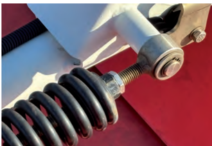
Obr. 5: Kontrola a nastavení přítlaku pomocí pružin (2). Zdroj: Vlastní.
