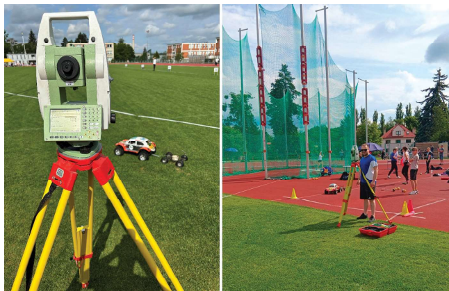
Obr. 2: Totální měřicí stanice – připravená na atletickou soutěž a průběh měření (Stadion mládeže ve Zlíně). Zdroj: Vlastní
