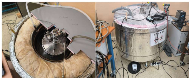
Obr. 7: Vlevo: foto z kompletace systému. Tlaková nádoba je vložena do izolované nádrže s temperační spirálou. Vpravo: Zkompletovaný systém s víkem, tlakoměrem a kapalinovým termostatem s oběhovým čerpadlem
