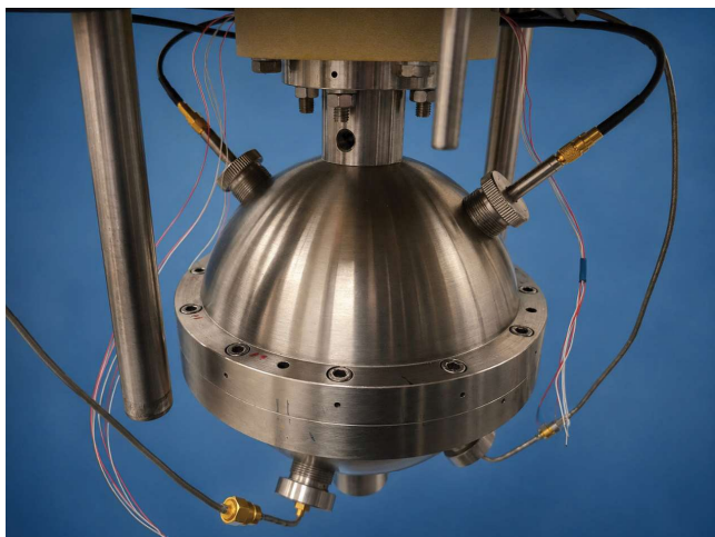
Obr. 2: Sférický rezonátor akustického plynového teploměru v ČMI
