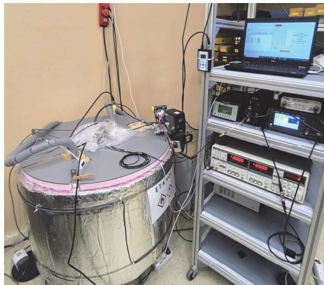
Obr. 1: Podoba sestavy státního etalonu termodynamické teploty na konci roku 2025
