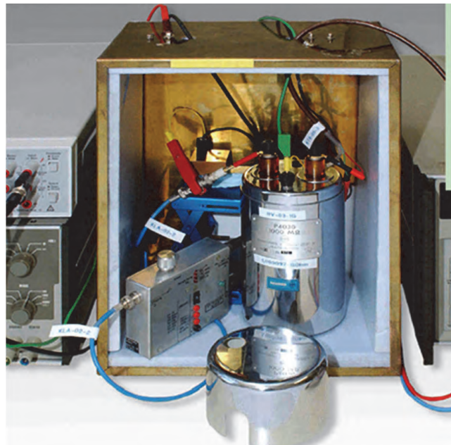
Obr. 5: Pomocný stínící a tepelně izolační box zpřesní a usnadní měření
