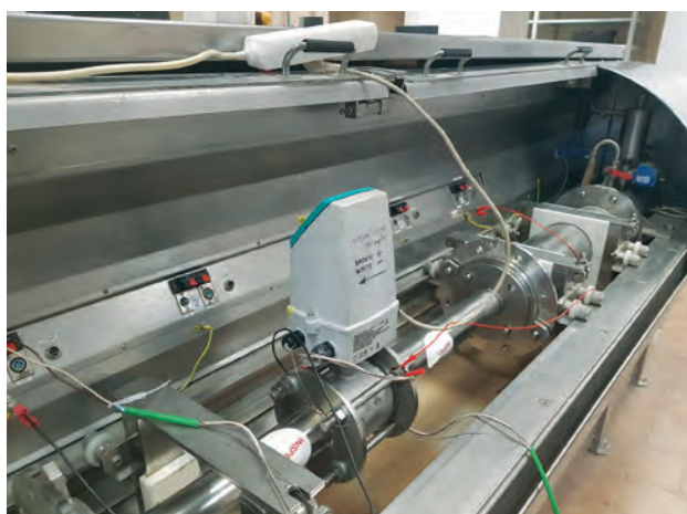
Obr. 7: Zapojení indukčního průtokoměru Siemens do měřicí stanice v referenční laboratoři
