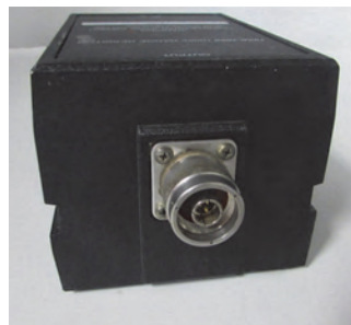
Obr. 7: Předřadný odpor pro přesná měření je někdy i rozměrné zařízení.
