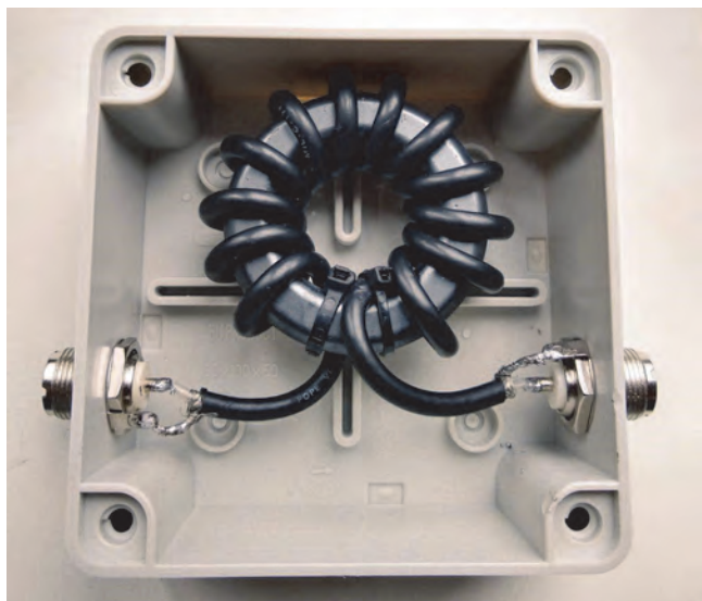
Obr. 4: Koaxiální tlumivka (choke) je malý zázrak v boji proti rušení. Užitečný signál procházející tlumivkou dvěma vodiči tlumivku nevidí (jde jedním tam a druhým zpět), rušícímu (souřadovému) signálu klade tlumivka překážku.
