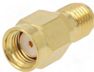
Obr. 12: Příklad provedení oddělovacího konektoru (connector saver), který je možné nasadit na vstupní konektor v kalibrační laboratoři tam, kde by mohl zákazníkův konektor s defektem omylem poškodit drahý přístroj (etalon).
