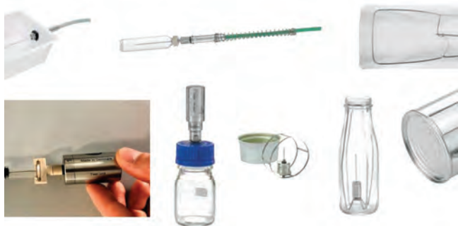
Obr. 11: Příslušenství pro správné uchycení snímačů k produktu při parní sterilizaci
