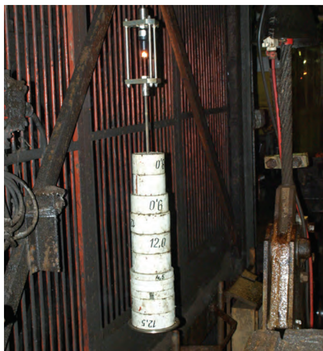
Obr. 1: Závaží na drátu pro připojovací měření ve vtažné jámě ČSM Zdroj: OKD
