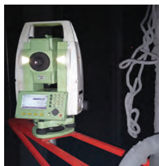
Obr. 3: Uchycení totální stanice Leica TS02 při měření ve výdušné jámě ČSM Sever Zdroj: OKD
