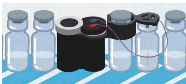
Obr. 15: Příklad 2 - Termočlánek zavedený do lahvičky a připojený k dataloggeru při lyofilizaci
