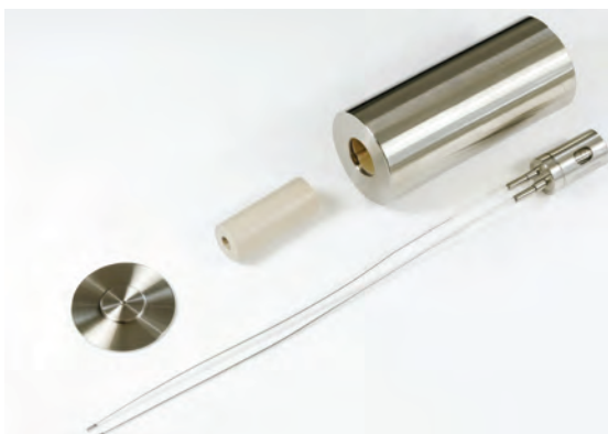
Obr. 13: Tepelná bariéra pro ochranu elektroniky dataloggeru
