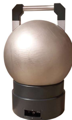
Obr. 7: Spektrometr SP2 italského výrobce ELSE Nuclear.
