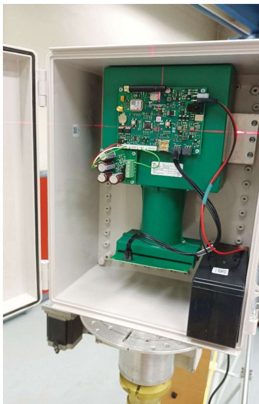
Obr. 13: Čtvercový scintilační detektor a fotonásobič v zeleném plastovém obalu tvoří jádro sondy Finapp.
