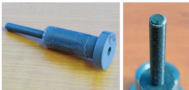
Obr. 8: Přípravek pro přesné zaměření osy kolimátoru na ohnisko rentgenky (vlevo). Otvor v podstavě přípravku je téměř nezatelný (vpravo). [16]
