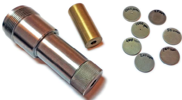
Obr. 4: Původní ocelový kolimátor se sadou wolframových kolimačních disků [14].
