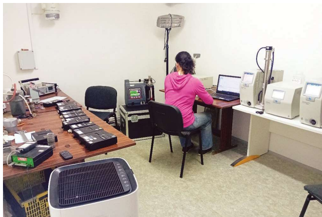
Obr. 5: Testování metodiky stanovení aktivitní velikostní distribuce krátkodobých produktů přeměny radonu v testovací místnosti SÚJCHBO, v.v.i.
