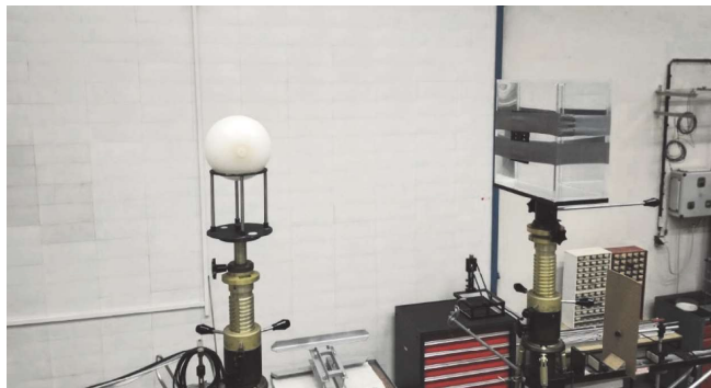
Obr. 3: Ozařování osobních dozimetrů na vodním fantomu.
