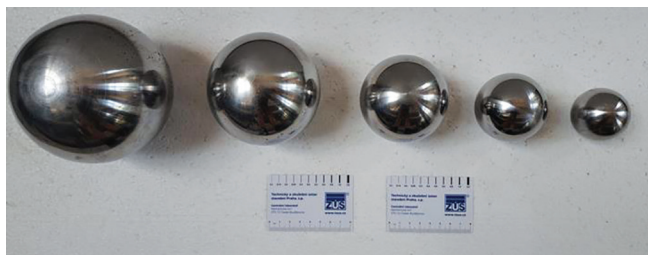
Obr. 3: Sada ocelových koulí pro zkoušku rázem dle EN 13497 o váze 0,51 kg až 7,91 kg
