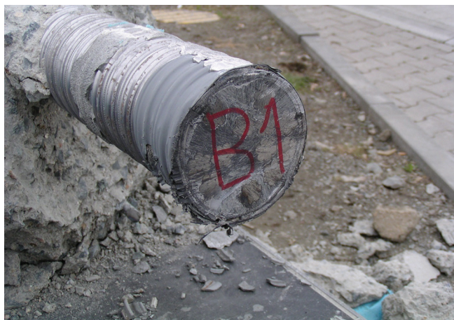
Obr. 4: Příčný řez kabelovým kanálkem po injektáži
