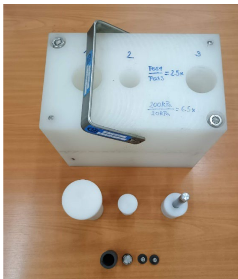
Obr. 11: Kalibrátor určený pro měření velmi nízkých emisí neutronů z radionuklidových zdrojů.
