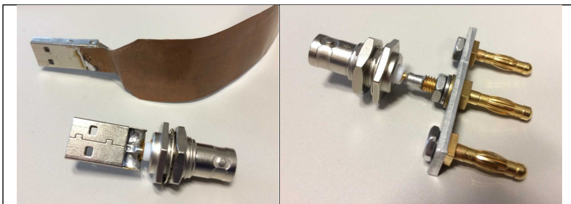
Obr. 1: Ukázka adaptérů pro připojení zařízení používaných v EMC k vektorovému analyzátoru obvodů
