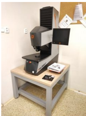
Obr. 14: Sestava státního etalonu pro modifikovanou metodu
