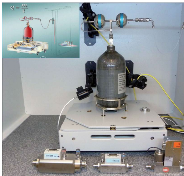
Obr. 6: Primární gravimetrický etalon malého hmotnostního průtoku (GFS) a sekundární etalony Molbloc
