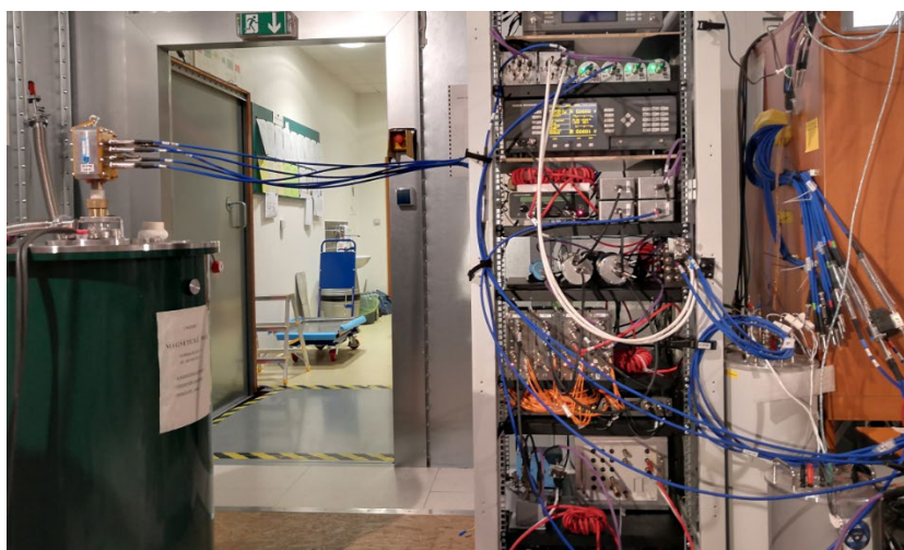
Obr. 3: Kryostat s kvantovou strukturou, digitálním impedančním můstkem a etalony elektrického odporu a kapacity (v termostatu)
