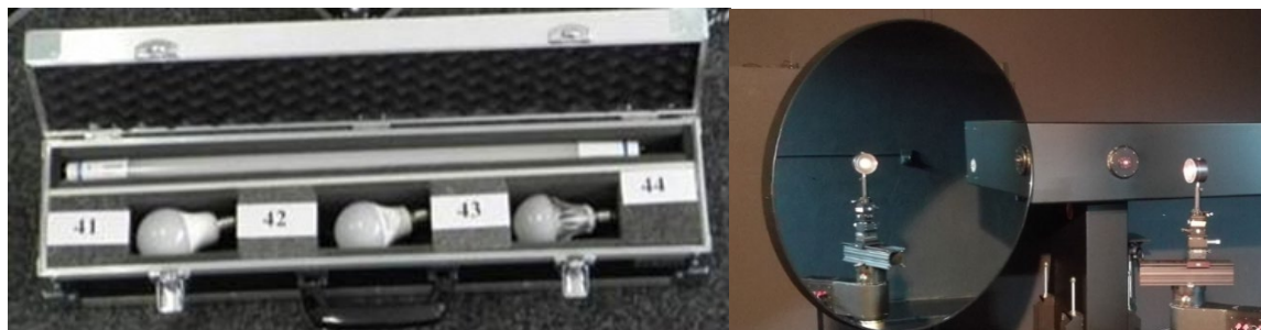
Obr. 18: Nová sada LED sekundárních etalonů celkového světelného toku (vlevo) a snímek aparatury zrcadlového gonio-fotometru při procesu navazování na přenosový etalon svítivosti LIS-A s přímou návazností na PQED-UPP (vpravo).
