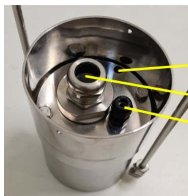
Obrázek 8: Realizace měření relativní vlhkosti suchého vzduchu v rozsahu pod 10 % za atmosférického tlaku
