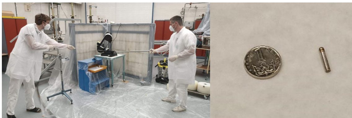
Obrázek 10: Rozebírání kovového obalu (vlevo). Vlastní neutronový zdroj ^{252}\text{Cf} vyjmutý z obalu (vpravo).
