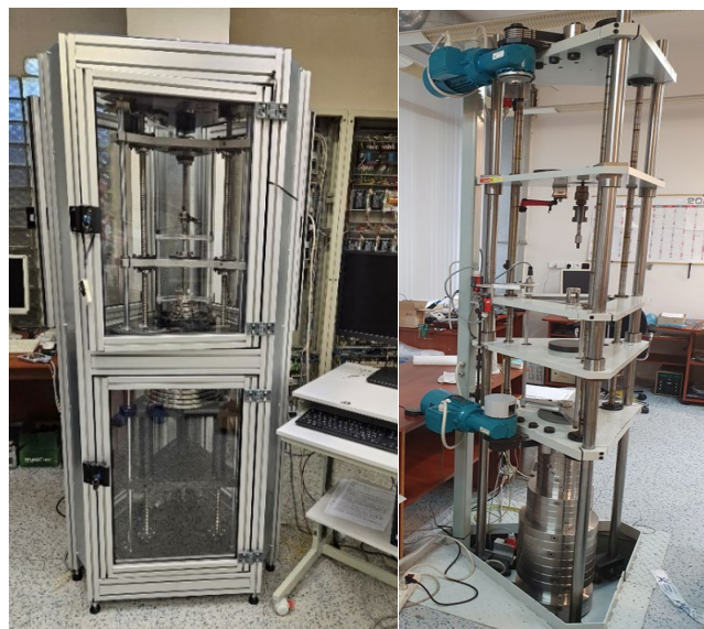
Obrázek 9: Realizace státního etalonu síly ESZ 500 N a ESZ 3 kN
