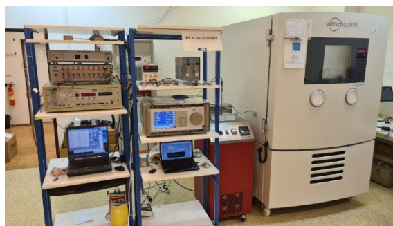
Obrázek 8: Realizace měření relativní vlhkosti suchého vzduchu v rozsahu pod 10 % za atmosférického tlaku
