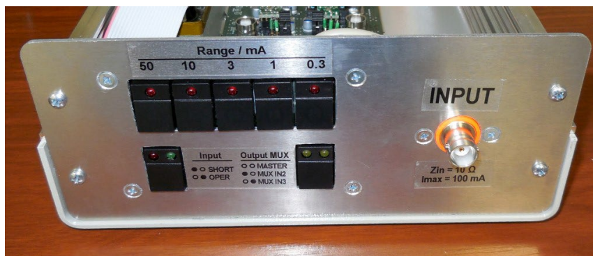
Obrázek 4: Prototyp více rozsahového aktivního proudového bočníku pro malé AC/DC proudy
