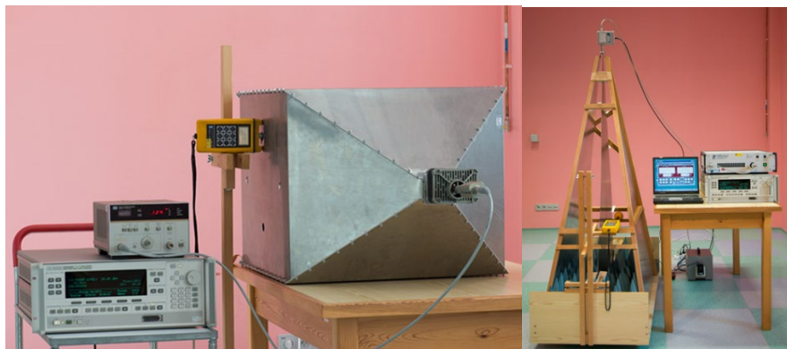
Obrázek 3: Kalibrace sond v pravoúhlé TEM cele v kmitočtovém rozsahu do 250 MHz a v pyramidální TEM cele v kmitočtovém rozsahu od 250 MHz do 1 GHz
